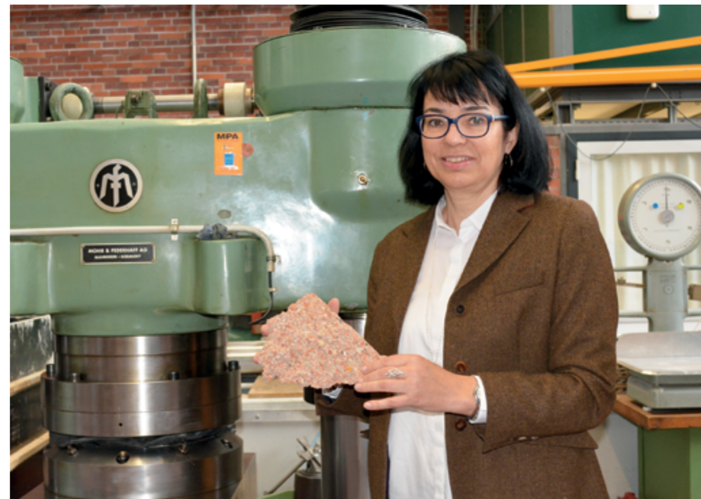
Prof. Dr. Sylvia Stürmer zeigt im Baustoffprüflabor der Hochschule Konstanz mit einem Teil eines Leichtbeton-Mauersteins aus dem Technischen Rathaus von Tübingen ein Beispiel dafür, dass bereits in der Nachkriegszeit Abrissmaterial als Baumaterial für Neubauten wieder verwertet worden ist.
