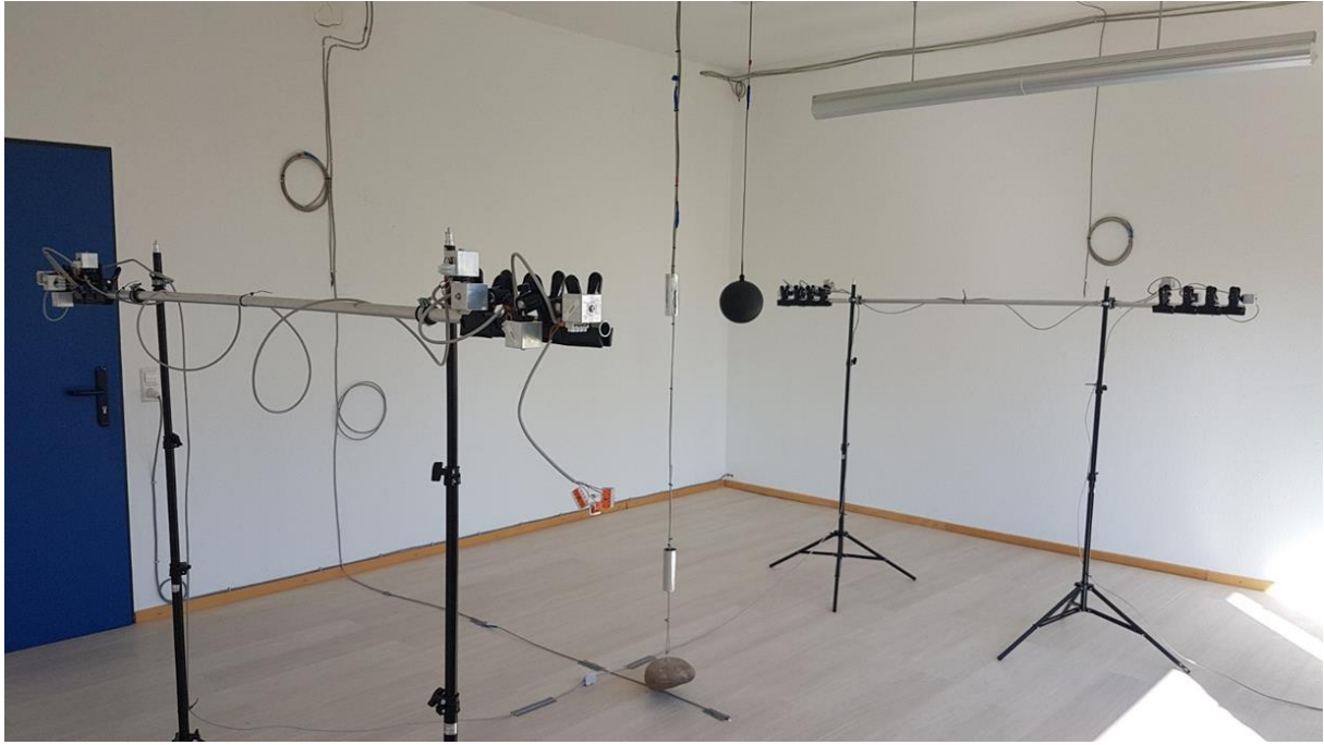
Abb. 50 Anordnung der 16 IR-Sensoren in Laborraum T3
