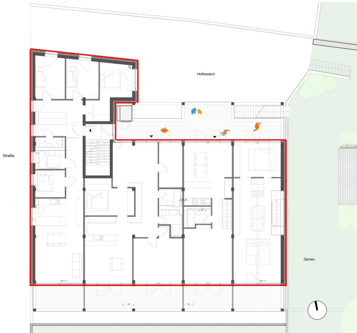
Abb. 12 Grundriss K76 Thermische Hülle [werk.um architekten, darmstadt]
